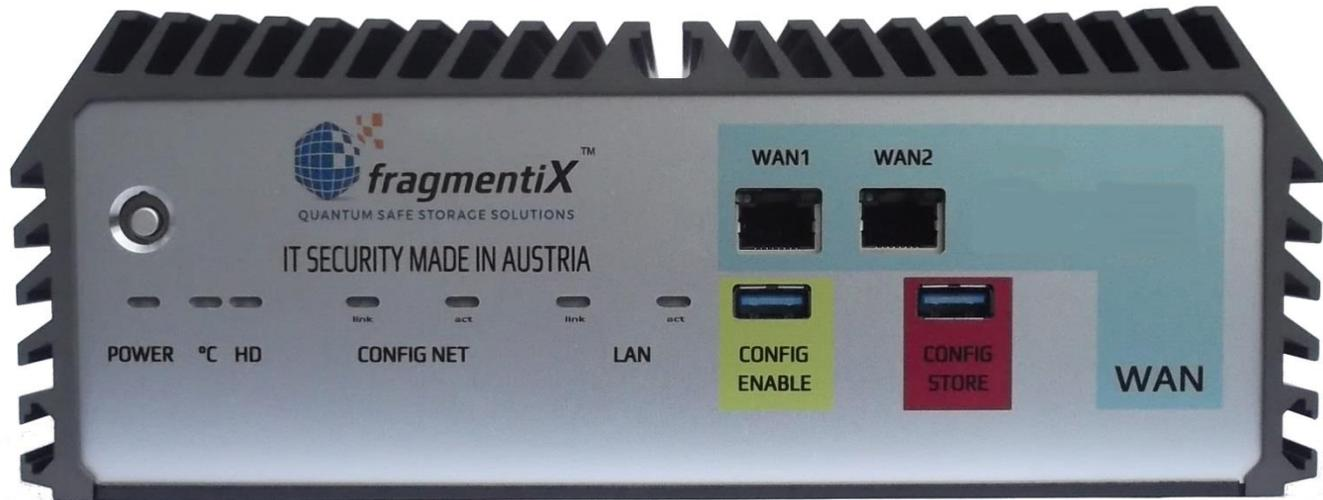
**2 x LAN Schnittstellen (1 x LAN als Netzlaufwerk, 1 x CONFIG ONLY)**
